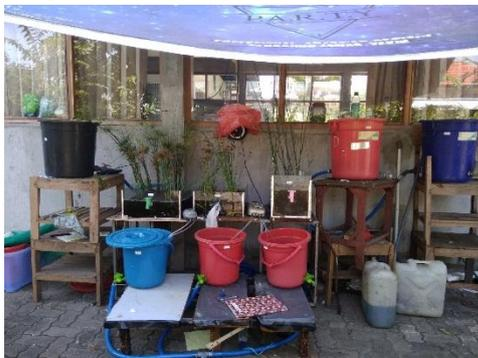
Gambar -1: Kombinasi Reaktor HSSFCW dan Reaktor Aerasi
