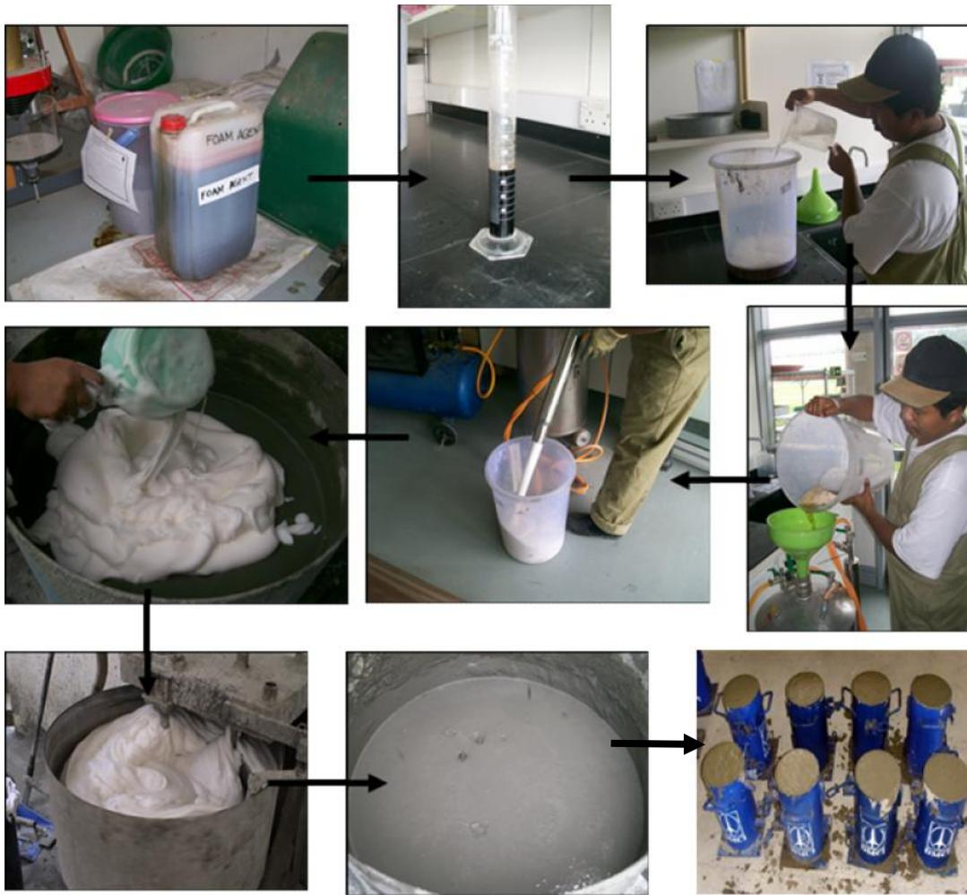
Gambar 8 Detail proses pembuatan benda uji BP-PKS
