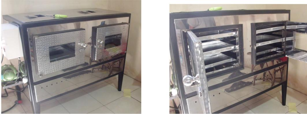
**Gambar 3.** Alat pengering kabinet
